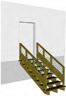
**Solution à encombrement réduit**, avec l'inconvénient d'une sortie donnant directement sur une marche d'escalier.
