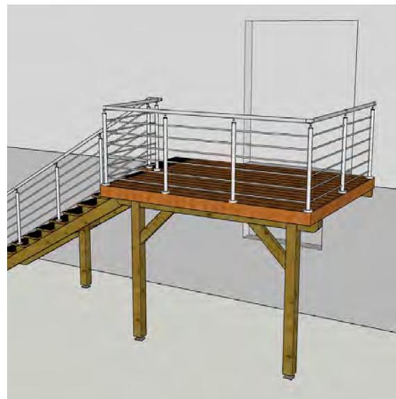
*Exemple d'un palier de sortie en bois exotique avec garde-corps inox*
