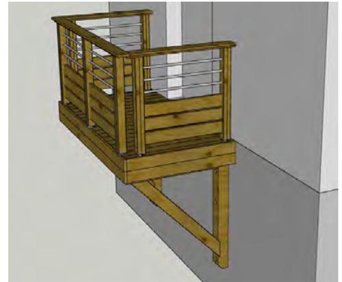
**Structure** en pin traité autoclave classe IV.
