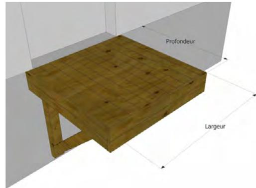
**Structure** en pin traité autoclave classe IV.
