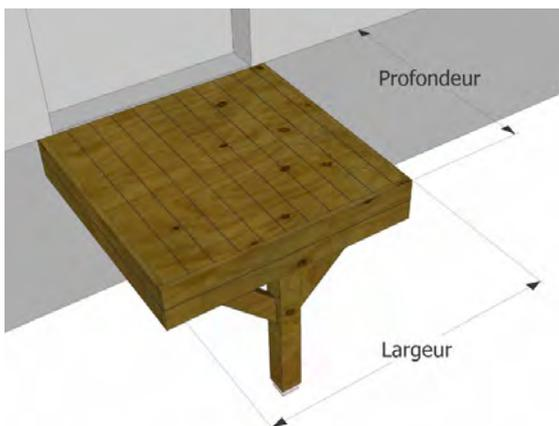
**Structure** en pin traité autoclave classe IV.
