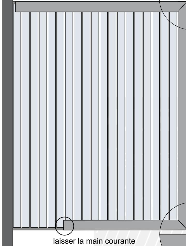
Adapter la main courante à l'angle en vérifiant les niveaux verticaux des poteaux
