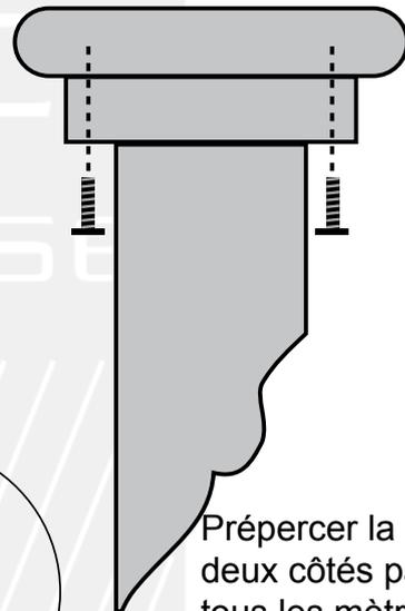
Prépercer la filante des deux côtés par en dessous tous les mètres avec la mèche avec fraise et fixer avec une vis inox 40/4,5
