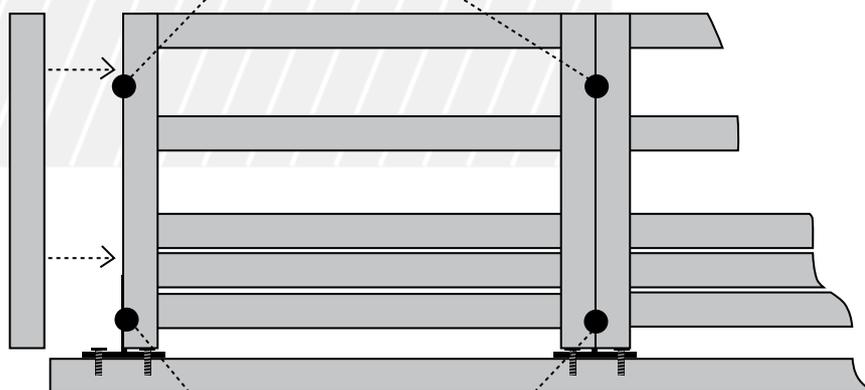
Fixer les panneaux sur l'ancrage en utilisant les boulons chromés 8/90, rondelles et écrous avec la clé de 13
